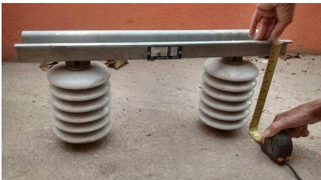
**Figura 11. Faca unipolar – equipamento de rede elétrica (Casa da Maria).**
