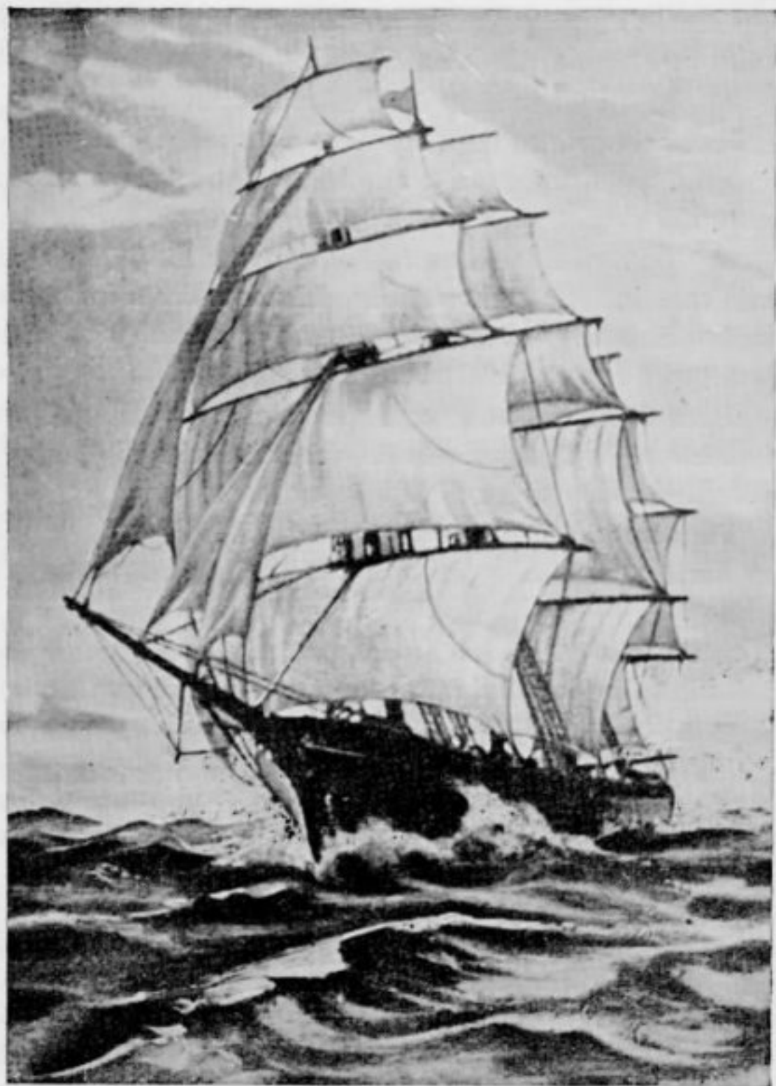
FIG. IX — De vento em pôpa — Gravura da revista Square. Representa uma Galera de princípios do século XIX e muito comum nas grandes esquadras dos países europeus da época. Era o veleiro mais completo que se conhecia com três mastros que ofereciam uma enorme superfície de pano, a qual auriéntava a sua velocidade quando o vento "soprava de feição".
