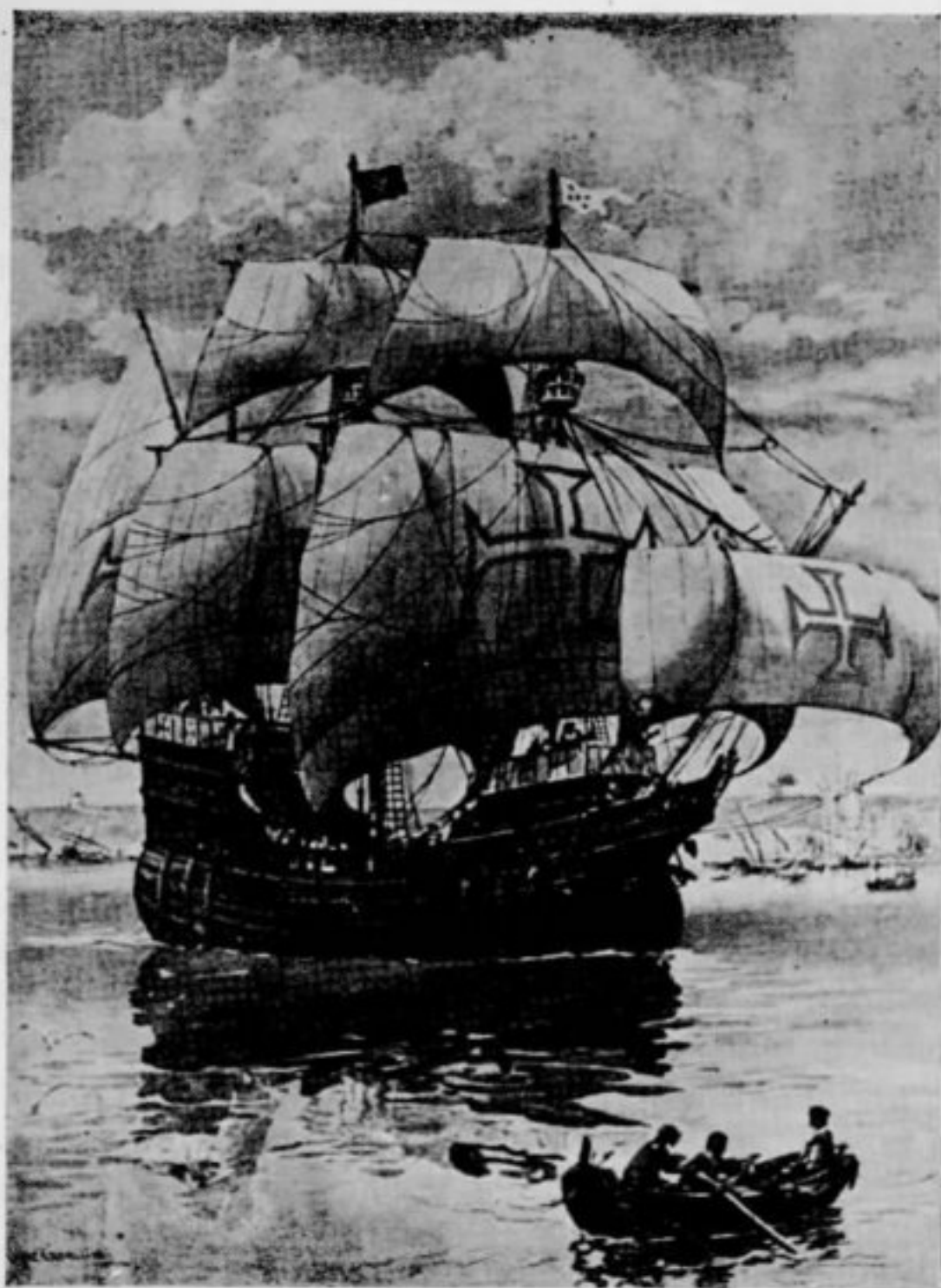
FIG. VII — Reprodução de um quadro de Roque Gameiro. Caravela dos séculos XV, e XVI, acastelada à proa e à pôpa, armando nos dois primeiros mastros duas velas redondas e uma latina no 3.º a ré; notar nessas velas a cruz, que é a da Bandeira da Ordem de Cristo para as Índias, notar igualmente no tópo dos 2 mastros respectivamente: no 1.º a bandeira das Quinas para a navegação e no 2.º a bandeira da Esfera, pendão de D. Manuel, e portanto um navio português. Este tipo de navio é comum, com ligeiras modificações aos usados pelas outras nações durante os séculos XV e XVI para as viagens oceânicas.
